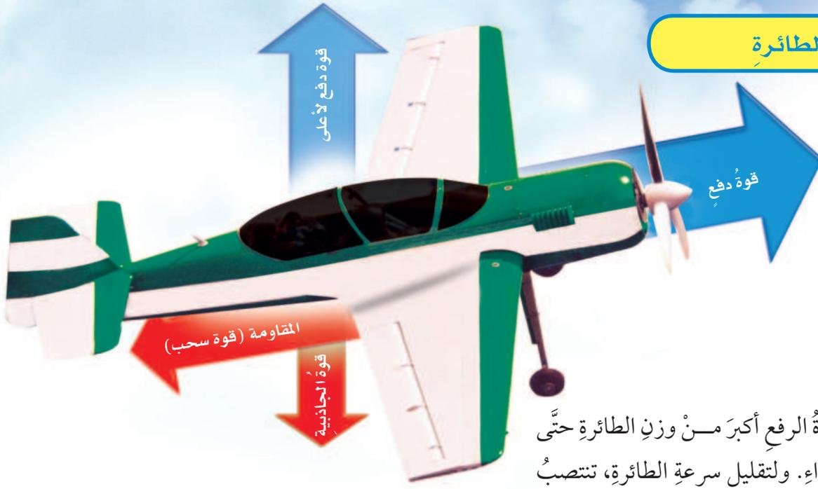
ويجب أن تكون قوة الرفع أكبر من وزن الطائرة حتى ترتفع الطائرة في الهواء. ولتقليل سرعة الطائرة، تنتصب قطع فلزية مستوية وعريضة فتصطدم بالهواء مما يسبب إبطاء حركة الطائرة. وتسمى هذه القوى قوى المقاومة، وهي قوى سحب تعيق حركة الطائرة.
