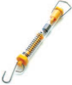
١ لقياس الوزن نستعمل الميزان النابضي (الزنبركي). الوزن مقدار قوة جذب الأرض للجسم، ويقاس وزن الجسم بوحدة النيوتن.
