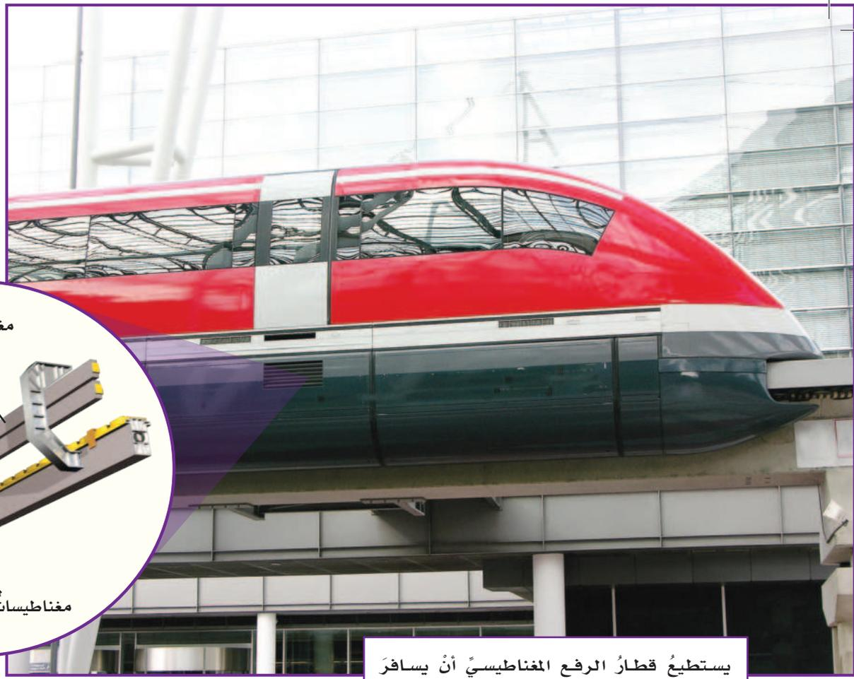
يستطيع قطار الرفع المغناطيسي أن يسافر بسرعة ٤٠٠ كم / ساعة.
