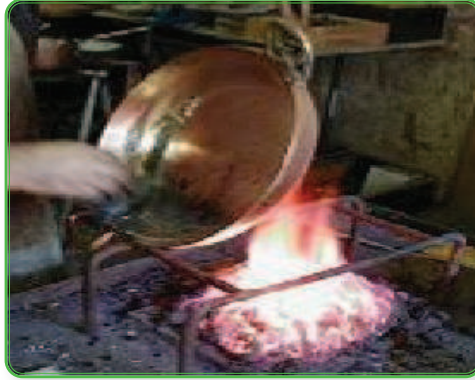
الشكل (٢٧): التخمير «تسخين المعدن لإكسابه اللدونة».
