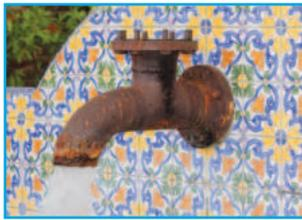
**التآكل** تلف جزئي أو كلي للمواد المصنوعة من الفلزات؛ بسبب تفاعلها مع اللافلزات.
